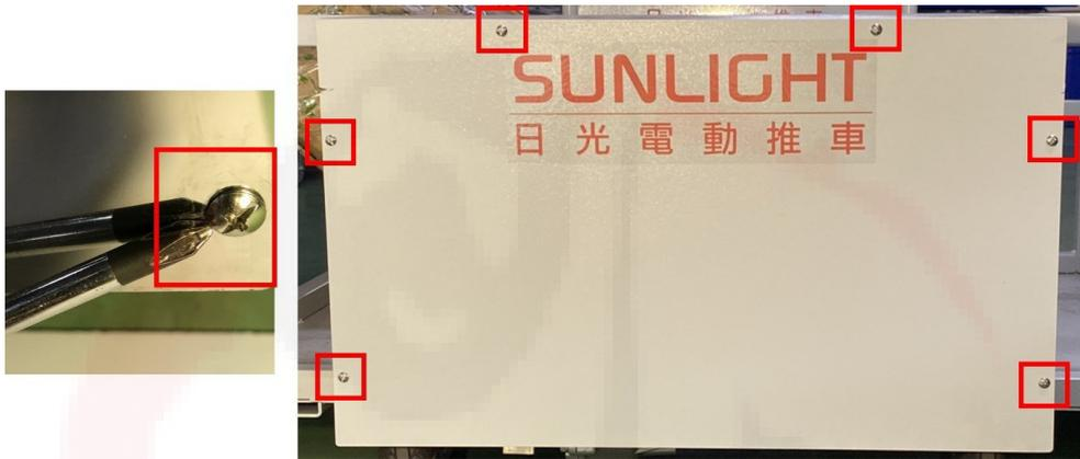
(三) 請依照①②③④⑤⑥⑦的順序將電池配線拆下後換上新電池，再依照⑦⑥⑤④③②①的順序將電池配線對接上即電池更換完畢。
