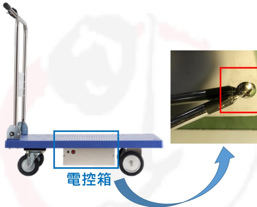
(三) 請依照①②的順序將電池配線拆下後換上新電池，再依照②①的順序將電池配線對接上即電池更換完畢。
